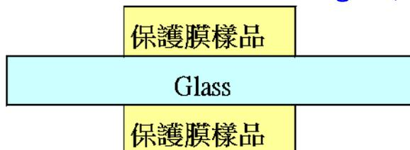
進行耐酸(HF~20%/1hr)測試, 確認保護膜 Glass 的保護性及是否殘膠於 Glass 表面?
